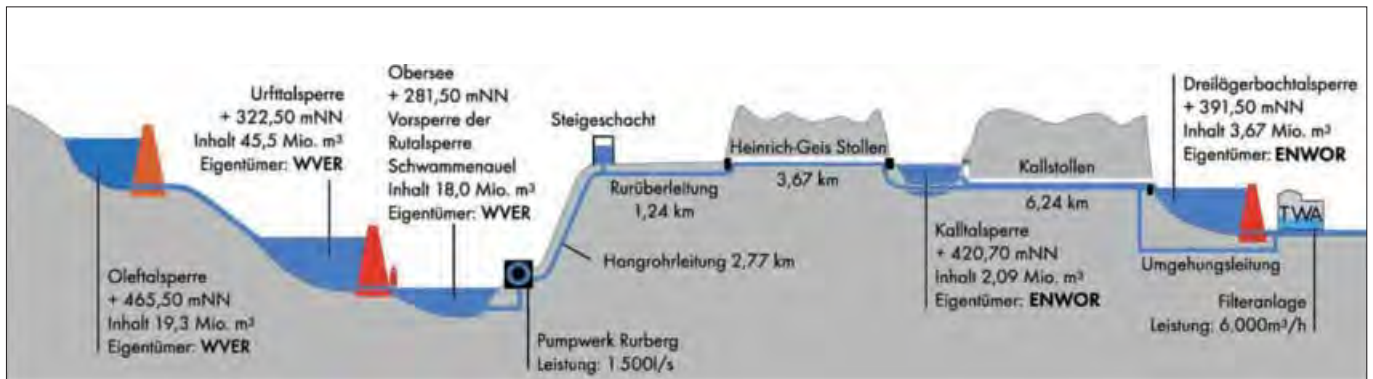
Abbildung 316: Überblick über den Talsperrenverbund zur Trinkwasserbereitstellung (Quelle: WASSERGEWINNUNGS- UND -AUFBEREITUNGSGESELLSCHAFT NORD-EIFEL 2011, schriftl., 2013a, b)
