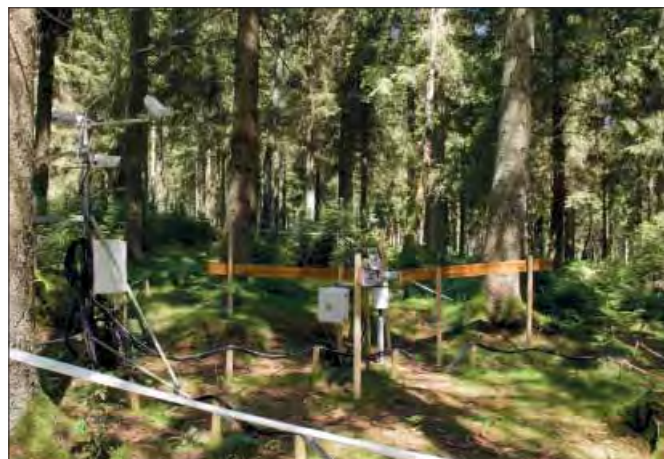
Abbildung 84: Messvorrichtung zur Ermittlung des Bestandsniederschlags im Fichtenwald des TERENO-Projektgebietes im oberen Wüstabachtal (Foto: Andreas Pardey)
